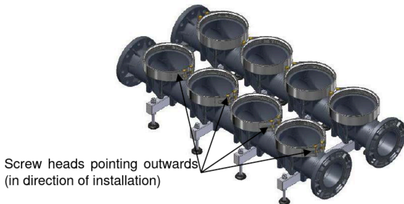
Рисунок 10-7: Выравнивание резьбового соединения inge® Двухрядные трубные муфты Ultra S 250 конфигурация в ряд
