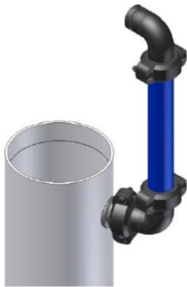
Рисунок 10-10: Прозрачная труба для фильтрации с гибкие 2-дюймовые муфты
